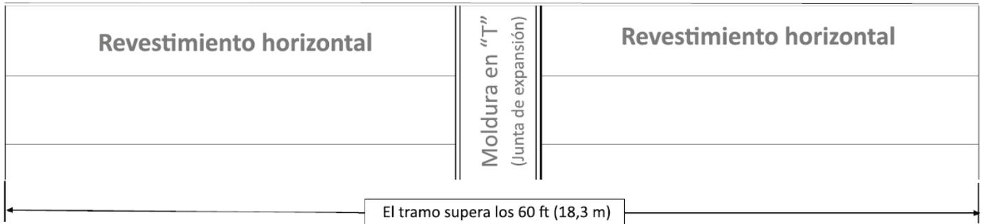
1. Instale primero el receptor de moldura 6915, antes de instalar el revestimiento (como lo haría con todas las molduras).
