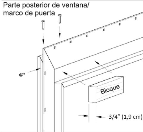
7. Conecte las esquinas en inglete y el bloque juntos colocando un tornillo en el bolsillo de la moldura lineal y asegurándose de atrapar el extremo corto del bloque. Fije dos tornillos en el bolsillo de la segunda moldura lineal asegurándose de atrapar el extremo largo del bloque.
