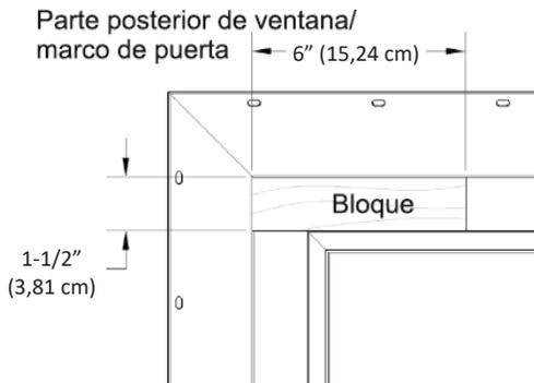
8. La moldura lineal debe fijarse a la pared colocando clavos en el reborde de clavos cada 3 ranuras.
